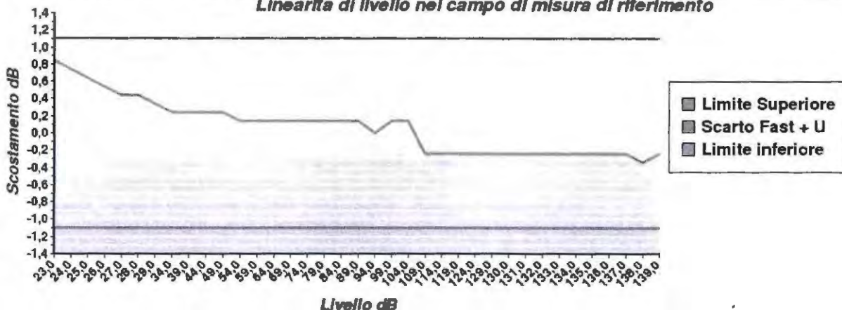
Linearità di livello nel campo di misura di riferimento
